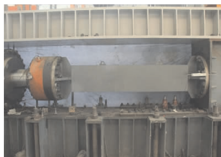
图1 装配式屈曲约束支撑构造现场试验照片
